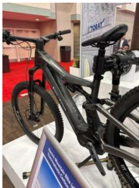
図1 3 東レの熱可塑性 CFRP を使ったマウンテンバイクの展示
