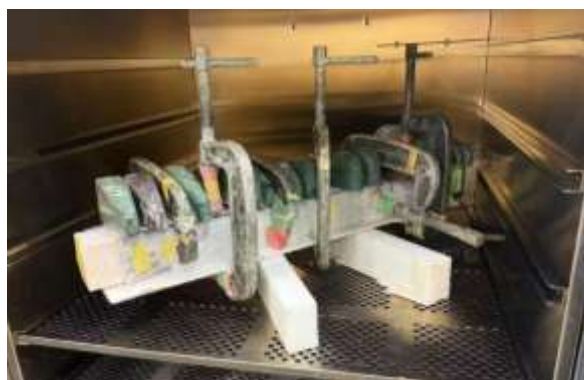
図5 加熱・加圧の様子
